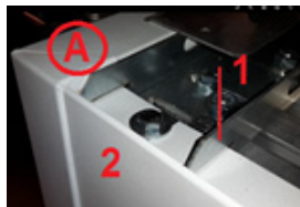
Fot. 1 Montaż/demontaż panela górnego
