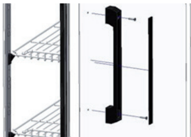
Rys.3 Mocowanie uchwyty drzwi
