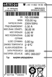
Rys.13 Poglądowa tabliczka znamionowa
